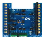
X-NUCLEO-IOD02A1 基于面向STM32 Nucleo 的L6364Q的双通道IO- Link设备扩展板
