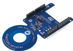
X-NUCLEO-NFC07A1 基于ST25DV-I2C的动态NFC标签Nucleo扩展板
