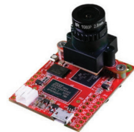
OpenMV Cam H7机器视觉板，具有嵌入式STM32H743VI MCU
