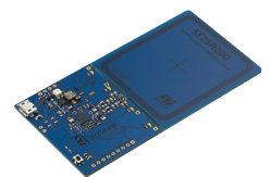
ST25R200-EMVCo 基于ST25R200的NFC/RFID读写器评估板
