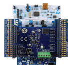
P-NUCLEO-IOD01A1 IO-Link设备的STM32 Nucleo套件，与IO-Link v1.1完全兼容（物理层和 协议栈）
