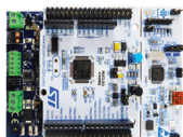
P-NUCLEO-IOM01M1 IO-Link主设备的STM32 Nucleo套件，具有IO-Link v1.1物理层和协议栈
