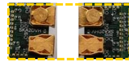
SKA2DVH SKA2DHV RF modules
