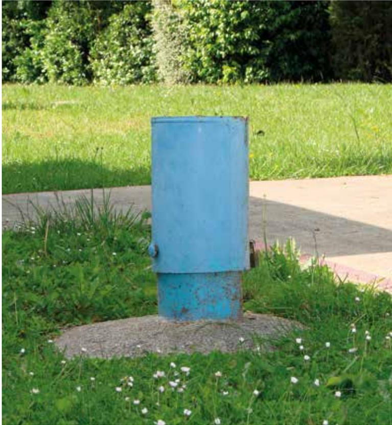
Depuis 1995, le site de Tours a installé des piézomètres (forages permettant le prélèvement et le contrôle des eaux de sous-sol) afin de mesurer l'évolution de la qualité des eaux souterraines.
