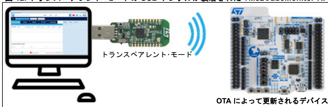
図 12. トランスペアレント・モードの USB ドングルが装着された TM32CubeMonitor-RF
