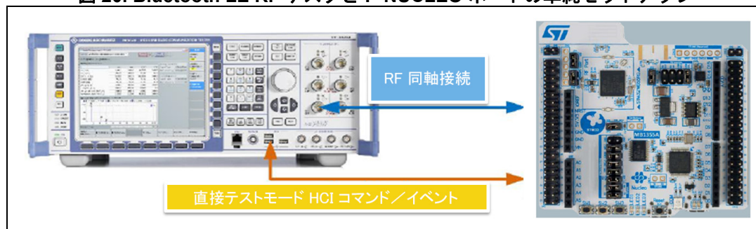
図 20. Bluetooth LE RF テスタと P-NUCLEO ボードの単純セットアップ
