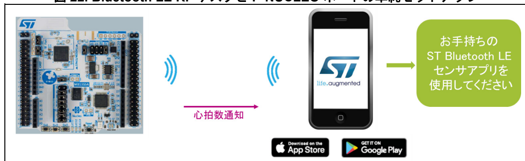
図 22. Bluetooth LE RF テスタと P-NUCLEO ボードの単純セットアップ
