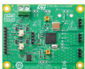
EVALMASTERGAN* 2個の650Vエンハンスメント型 GaN HEMTを内蔵した高電力密度 ハーフブリッジ高電圧ドライバ
