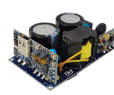
STEVAL-USBPD27S PPS機能に対応した 27W USB Type-C Power Delivery 3.1アダプタ
