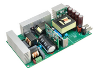
EVL400W-80PL CCM PFCおよびHB LLCアナログ・ コントローラ搭載、12V - 400Wアダプタ
